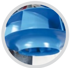
Lauftrad ■ Höchste Effizienz (bis zu 90%) ■ Wuchtklasse G2.5 als Standard ■ Schaufelmaterialien: Naxtra 700/900/1000 und 1.4462 für Edelstahl als Standard, höhere chem. Beständigkeit möglich Impeller ■ Highest efficiency (up to 90%) ■ Balanced to G2.5 as standard ■ Materials for blades: Naxtra 700/900/1000 and 1.4462 for stainless steel impellers as standard, higher chemical resistance possible
